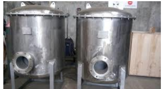
FABRIKASI TANGKI STAILESS STEEL
