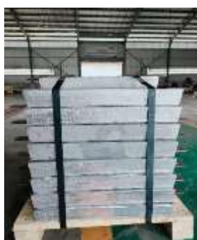
Oct 2021 - Sacrificial Aluminium Anode for Jetty Pile - PLTU Anggrek 1 dan 2, Gorontalo
