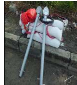
Februari 2015 - Supply Material Sacrificial Magnesium Anode for Pipeline - PT. Perusahaan Gas Negara, Tambak Lorok, Semarang, Jateng
