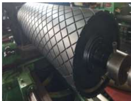
Aplikasi Rubber Lagging di Lokasi atau di Pabrik/Workshop
