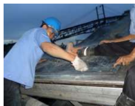
Hot Splicing di Lokasi atau di Pabrik/Workshop
