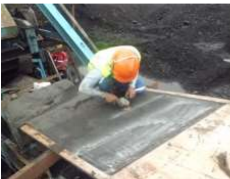
Cold Splicing di Lokasi atau di Pabrik/Workshop
