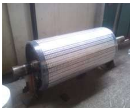
Aplikasi Ceramic Lagging di Lokasi atau di Pabrik/Workshop
