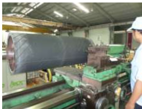
Aplikasi Rubber Lagging di Lokasi atau di Pabrik/Workshop
