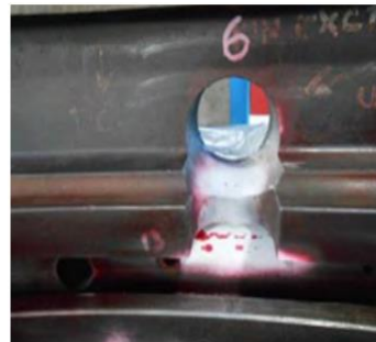
PERBAIKAN LUBANG BAUT TURBINE CASING GTG 2.3 UBP (TAMBAK LOROK)
