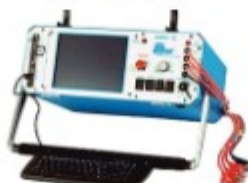
Surge Test Baker D15R
