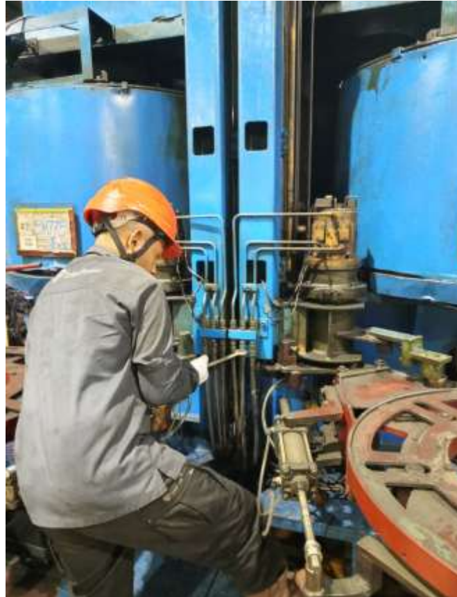
PT Elangperdana Tyre Pergantian dan pemasangan hose
