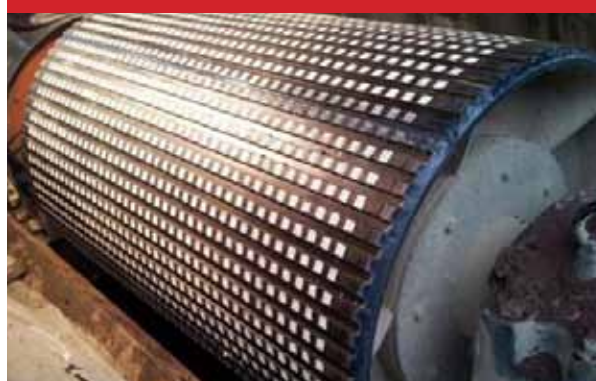
PEMASANGAN CERAMIC LAGGING
