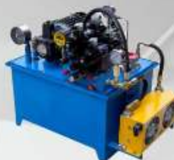
HPU FILTER PRESS WTP
